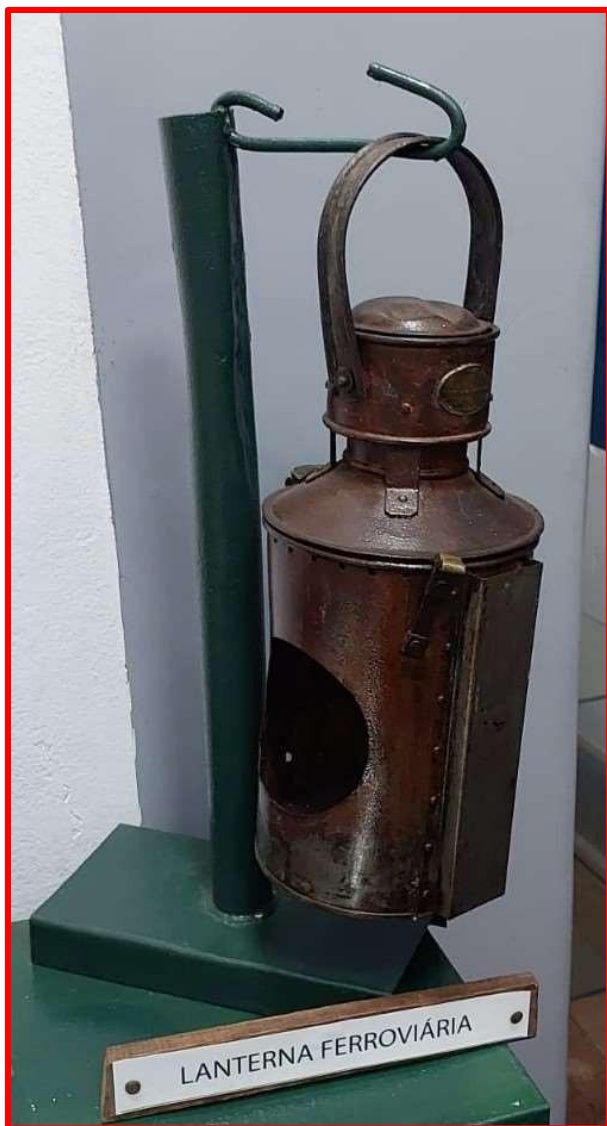
Antiga lanterna sinalizadora de Ferrovia completa com alça, fabricada na década de 1910 em latão e ferro pela Westinghouse Brake - London C Chippenham Signal C C o . Mede 0,66 x 0,40.
