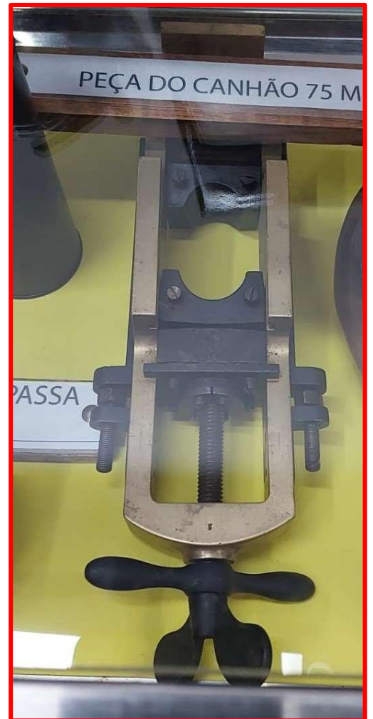
Peça do sistema de controle de elevação do Canhão 75 mm. KRUPP, alemão. Mede 0,30 x 0,10 cm.
