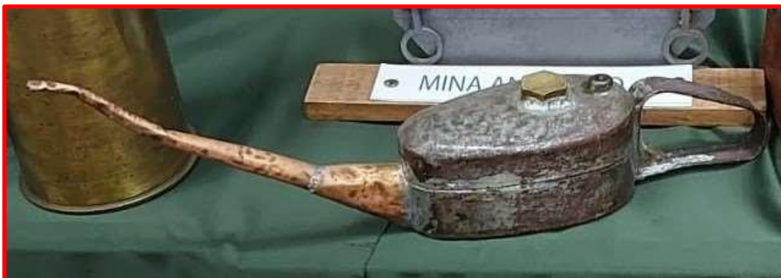
Antigo lubrificador a óleo com bojo de metal e bico longo de cobre, utilizado para canhões, metralhadoras.
